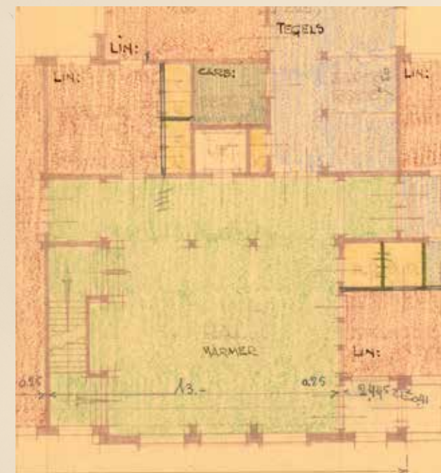
Detail van de bouwteke- ning van de begane grond uit het bestek van het Geologisch Instituut. Met kleur wordt het type vloer aangegeven. Groen: marmer, geel: hout, blauw: tegels, rood: linoleum.
